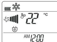
Režim rada hlađenje sa štednjom energije može uštedjeti energiju u radu hlađenje i zdravo odvlaživanje, zato jer može učinkovito raditi postavljajući vrijeme za prilagođavanje tijela sukladno promjeni vremena (sata) i temperature i automatski postavljajući željenu temperaturu.
