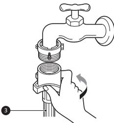
**Conexión de la manguera a presión con el grifo sin rosca**
