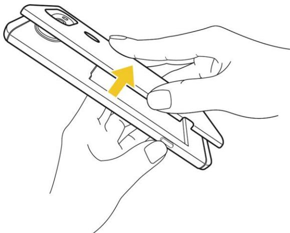
3. Alinee la batería con los contactos de la batería ① e insértela en su lugar ②. Después, para instalar la tapa trasera, debe alinearla sobre la parte trasera del teléfono.
