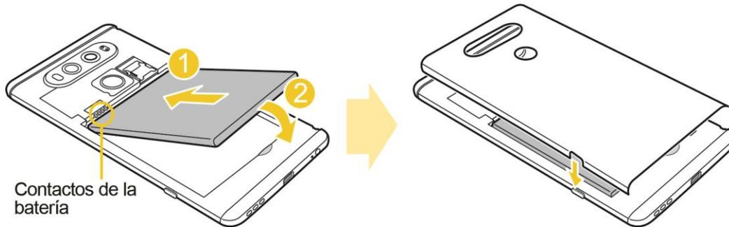
5. Primero, presione hacia abajo en el área **1** que aparece en la imagen a continuación. Luego, presione hacia abajo en **2** hasta que la tapa trasera quede firmemente sujeta.
