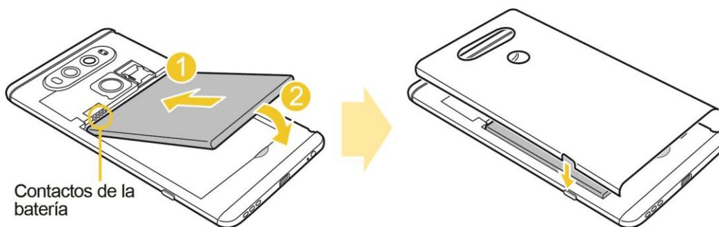
4. Primero, presione hacia abajo en el área ① que aparece en la imagen a continuación. Luego, presione hacia abajo en ② hasta que la tapa trasera quede firmemente sujeta.
