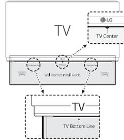
2. Si vous fixez la barre de son sur un mur en béton, utilisez des chevilles. Vous devrez percer quelques trous. Un gabarit (Guide d'installation des supports muraux) est fourni pour vous y aider. Utilisez-le pour repérer les endroits où vous devez percer.
