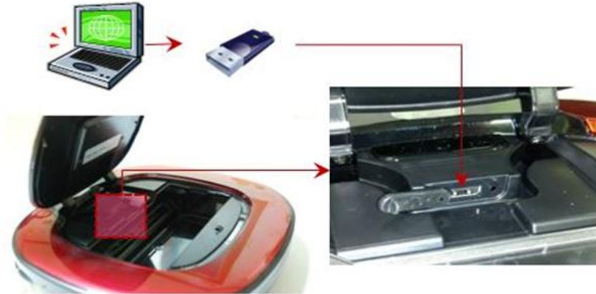
⑥ Encienda la máquina (ON) y pulse "Start / Stop". El mensaje de voz "Comenzando actualización de software", se reproducirá y la actualización se iniciará automáticamente..
