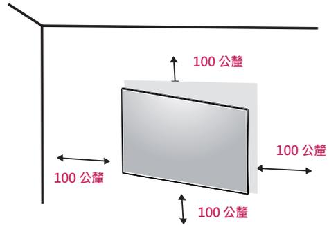
若要将顯示器安裝在牆上，請將壁掛支架（選購）裝到顯示器的背面。
