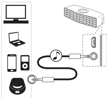
1. Conecte el dispositivo externo al conector Portable In de la unidad.
