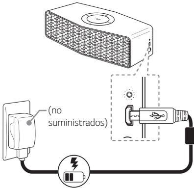
Si la batería se ha cargado completamente en el modo de carga, el indicador cambia de rojo a verde.
