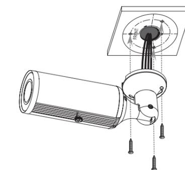
**Conecte el aislamiento impermeable del cable**
