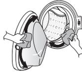
Reinigen Sie die Dichtung und das Türglas.
