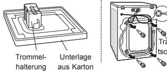
Transportschrauben und Trommelhalterung entfernen.
