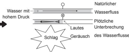
Stellen Sie den Wasserdruck durch Zudrehen des Wasserventils oder Wasserhahns im Haus ein.
