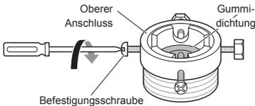
2 Nehmen Sie den Führungsring heraus, falls der Wasserhahn zu groß für den Adapter ist.
