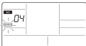
3 Dopo aver premuto il tasto **OK**, ricercare se l'unità interna collegata si avvia. Il singolo led on/off lampeggia con la rotazione e **SEARCH** l'LCD sta lampeggiando.
