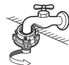
旋转下连接座直到上下连接座拧紧为止。（如未拧紧，会发生漏水）
