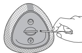
U slučaju da uređaj zablokira usled kvara, pritisnite otvor RESET pomoću predmeta kao što je čioda. Jedinica se onda potpuno isključuje.
