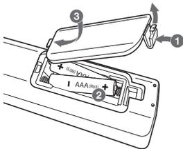
Retirez le couvercle du compartiment de la pile à l'arrière de la télécommande, puis insérez la pile en respectant la polarité **+** et **-**.
