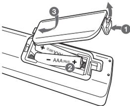
Retirez le couvercle du compartiment à piles situé au dos de la télécommande et insérez les piles en respectant les polarités **+** et **-**.
