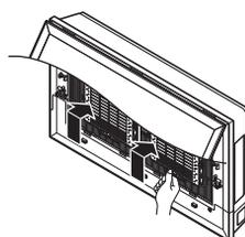
7. Insérez le filtre à air avec les deux mains et retirez le support.
