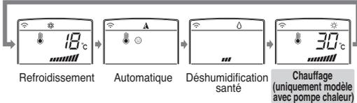
Refrigerissement    Automatique    Déshumidification santé    Chauffage (uniquement modèle avec pompe chaleur)
