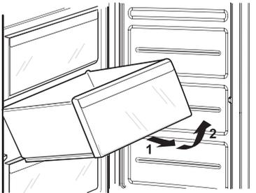
Para volver a instalar cualquier cajón en el compartimento de congelación, proceda en sentido inverso:
