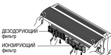
**Не касайтесь ИОНИЗИРУЮЩЕГО фильтра в течение 10 секунд после снятия решетки воздухозаборника, поскольку это может вызвать поражение электричеством.**
