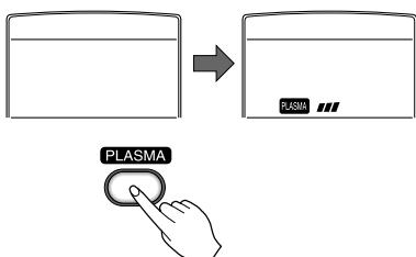
При нажатии одной кнопки ИОНИЗАЦИЯ включается только функция ИОНИЗАЦИОННОЙ очистки воздуха. В этом случае скорость вращения вентилятора низкая. Всего вентилятор имеет четыре скорости вращения – низкую, среднюю, высокую и максимальную. Каждое нажатие кнопки ( ) вызывает увеличение скорости вращения вентилятора на один шаг.
