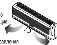
Настройка горизонтального направления потока воздуха производится вручную.
