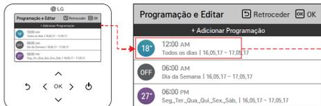
Pode verificar a informação de funcionamento do temporizador (funcionamento Ligado/Desligado modo de funcionamento, temperatura pretendida), hora do temporizador, período e dia da semana.
