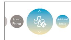
※ O ventilador auto. pode apenas ser utilizado quando o sensor de contaminação do ar (CO<sub>2</sub>) se encontra instalado.
