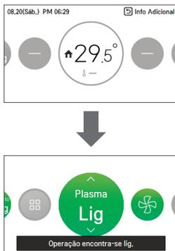
No caso de uma operação única de purificação de plasma, esta funciona no modo de ventilação / estado de fluxo de ar automático, e a direção do fluxo de ar, operada antes da operação única de purificação de plasma, está desligada.
