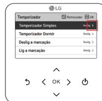
Em cada ecrã de detalhe do menu, tal como demonstrado na caixa na imagem da esquerda, se apenas o ícone “>” for exibido, pode deslocar-se para o ecrã de configuração de detalhe ao pressionar o botão [→(direita)] ou [OK].
