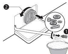
**4** 清潔排水泵過濾器後，取出排水泵過濾器並插入排水塞。
