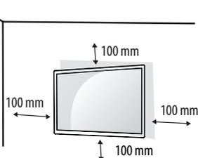
Ako televizor želite montirati na zid, priključite sučelje za montiranje na zid (dodatni dijelovi) na stražnji dio televizora.
