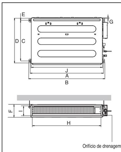
✳ **Instale a unidade a inclinar-se para o lado de um orifício de drenagem, como na figura para obter uma drenagem fácil da água.**
