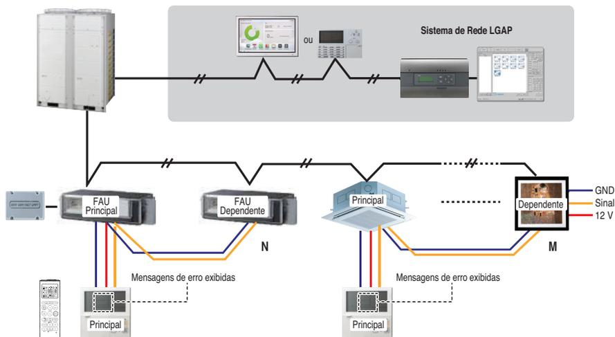
\* No caso de conexão com a unidade de interior padrão e a unidade de entrada de ar fresco, separe a unidade de entrada de ar fresco das unidades padrão. (N, M ≤ 16) (Porque as temperaturas configuradas são diferentes.)
