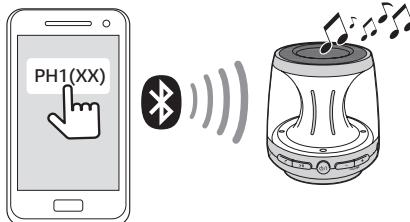
Воспроизводите желаемую музыку на устройстве **Bluetooth**. После выполнения сопряжения вы можете осуществлять воспроизведение с помощью кнопок на передней панели устройства.
