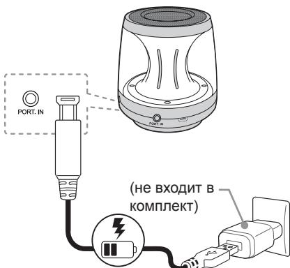
Если аккумулятор полностью заряжен в режиме зарядки, светодиод (КРАСНЫЙ) выключается.
