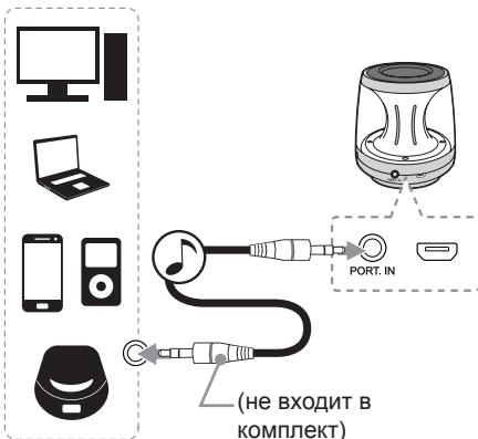
1. Подключите внешнее устройство к разъему Portable In на устройстве.
