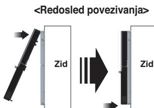
Kada želite da uklonite daljinski upravljač sa zida, uvucite odvlač u otvor sa donje strane, a zatim ga okrenite u smeru kazaljki na satu i daljinski upravljač će se odvojiti od zida.
