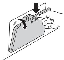
**2 拔下排水塞，將過濾器向左旋轉以將其打開。**
