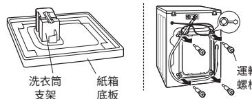
拆下運輸螺栓和洗衣筒支架。
