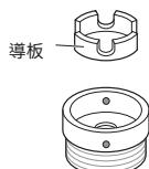
3 將接頭推到水龍頭的末端，以便使橡膠密封件形成不透水的連接。擰緊四顆固定螺絲。
