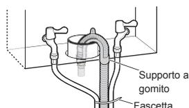
Reinstallare il tubo di scarico.
