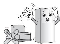
**Pazite da prilikom postavljanja i guranja hladnjaka ne priklještite i ne pritisnete električni kabel.**
