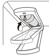
**5** Luego de reemplazar el filtro de agua, dispense 2.5 galones de agua (deje correr el agua por aproximadamente 5 minutos) para remover el aire atrapado y los contaminantes del sistema.
