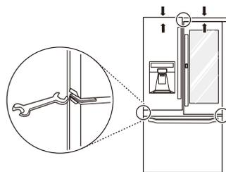
La puerta derecha del refrigerador no tiene una tuerca ajustable.
