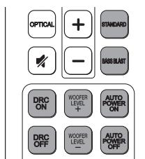
**STANDARD/BASS BLAST:** Izbor zvučnog efekta.
