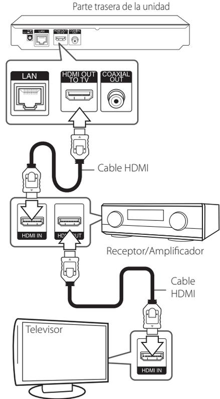
Conecte la toma de salida HDMI a la toma de entrada HDMI del TV utilizando un cable HDMI si el amplificador tiene una toma de salida HDMI.
