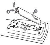
Retire la tapa del compartimento de la pila en la parte posterior del mando a distancia e inserte una pila R03 (tamaño AAA) con la polaridad correcta (+ y -).
