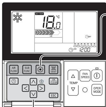
**1** Veuillez appuyer sur le bouton de configuration de la fonction. Si vous appuyez sur le bouton de configuration de la fonction de manière répétée, vous retournez au menu de configuration de l'heure. L'icône de réglage de l'heure s'affiche à ce moment et la date clignote au niveau de la zone d'indication de l'heure actuelle.
