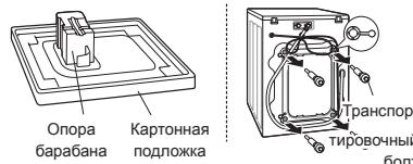
Снимите транспортировочные болты и опоры.
