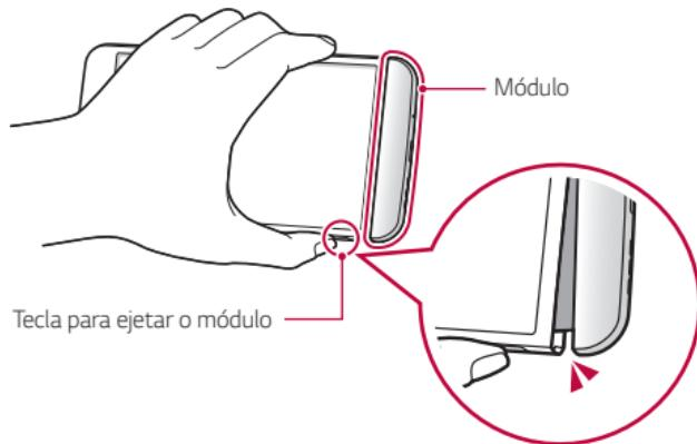
2 Agarre a secção intermédia do módulo ejetado e retire-o do dispositivo.
