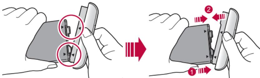
2 Segure a parte inferior do módulo, como mostrado na imagem abaixo, e faça deslizar cuidadosamente o módulo para o dispositivo até estarem bem encaixados.
