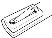
拆下遥控器背面的电池盖，放入一节 R03（型号为 AAA）电池，并且使  $\oplus$  和  $\ominus$  方向放置正确。
