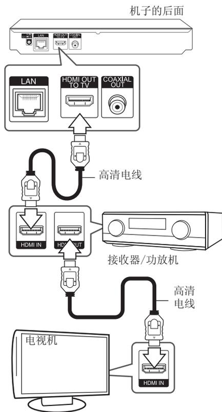
如果您的功放机有高清输出插孔，请使用 高清电线将功放机的高清输出插孔与电视机的高清输入插孔相连。
