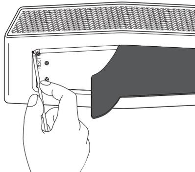
Si l'enceinte se bloque en raison d'un dysfonctionnement, retirez le cache en caoutchouc et appuyez dans le trou de réinitialisation à l'aide d'un objet fin tel qu'une aiguille. L'enceinte s'éteint ensuite complètement.
