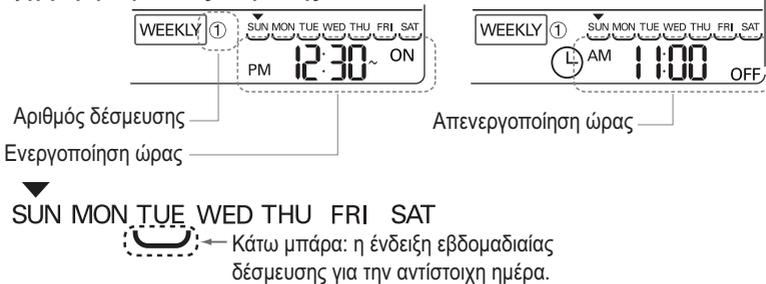
\* Η εσωτερική μονάδα ενεργοποιείται στην επιθυμητή θερμοκρασία, εφόσον διαμορφωθεί με τη χρήση του πλήκτρου επάνω/κάτω κατά τη διάρκεια προκαθορισμού του εβδομαδιαίου χρόνου λειτουργίας. (Εύρος επιλογής θερμοκρασίας: 18°C~30°C)
