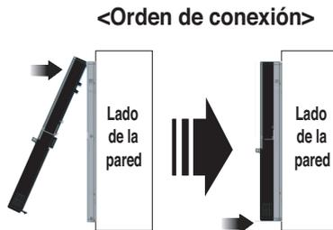
**Al separar el controlador remoto del panel de instalación, como muestra la imagen siguiente, después de insertar el destornillador en el orificio de separación inferior, gírelo en el sentido de las agujas del reloj y el controlador remoto se separará.**
