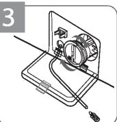
清除排水泵过滤器中的杂质。清洁完后顺时针转动排水泵过滤器, 将排水泵塞插回原处, 关上下盖。
