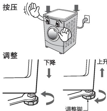
安装时分别按压洗衣机顶部对角线，如有晃动请调整底部调整脚至水平；在保证水平的情况下，底脚尽可能调低，并锁紧防松螺母以免振动噪音过大。
