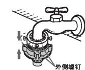
将上连接头抵住水龙头使其内部密封垫与水龙头充分接触。同时旋转外侧的两颗螺钉使其与水龙头接触后再用螺丝刀拧紧。
