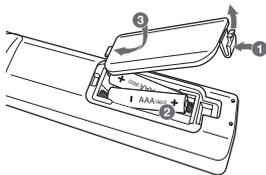
Retirez le couvercle au dos de la télécommande puis insérez deux piles (AAA) en respectant les polarités  $\oplus$  et  $\ominus$ .
