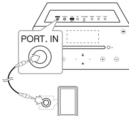
1. Raccordez le périphérique externe au connecteur **PORT. IN** de l'appareil.
