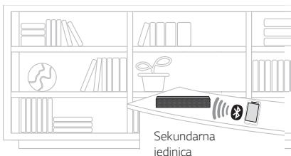
Uključite sekundarnu jedinicu tako, da prebacite prekidač načina uporabe na **PORTABLE**.
