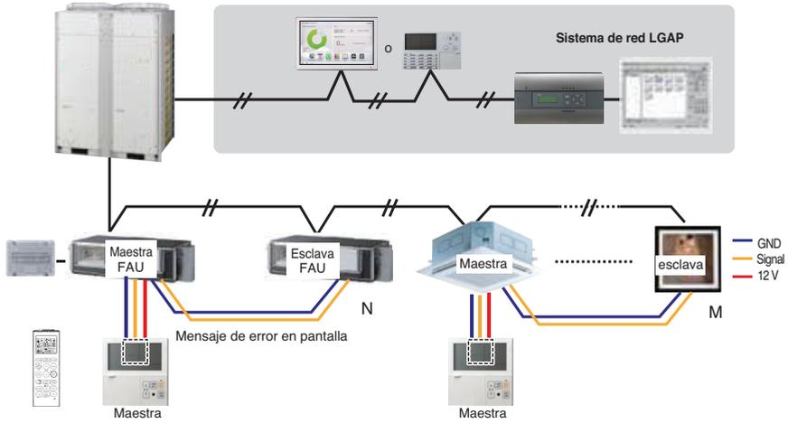
\* Si se realiza la conexión con unidad interior estándar y unidad de entrada de aire fresco, separe la unidad de aire fresco con unidades estándar. (N, M ≤ 16) (Porque las temperaturas de configuración son diferentes.)
