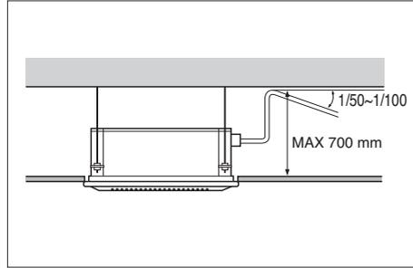
3. Deberá existir en todo momento un aislador térmico de 5 mm o más de grosor para el tubo de drenaje.
