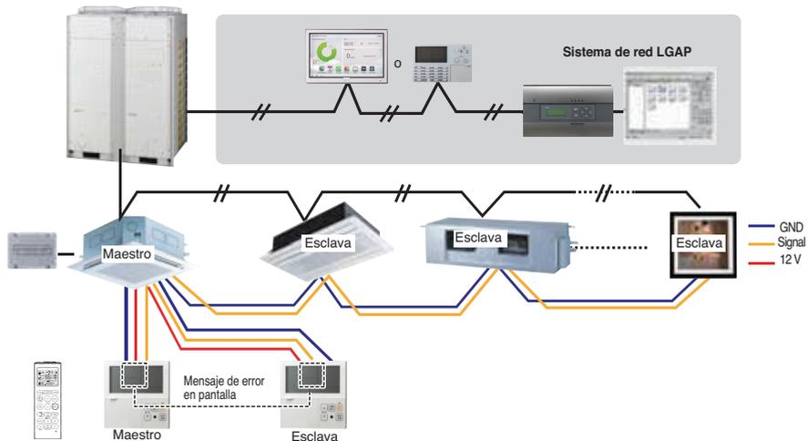
**1. Se pueden conectar dos controladores remotos con cable (máx.) con una unidad interior.**
