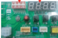
PCB de unidad exterior
