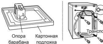
Снимите транспортировочные болты и опоры.
