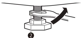
**4** Vérifiez que tous les écrous de blocage situés au bas de l'appareil sont correctement fixés.
