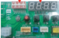
PCB de unidad exterior
