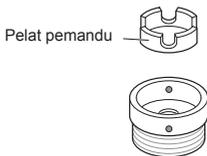
3 Tekan adaptor ke ujung keran sehingga segel karet membentuk sambungan yang kedap air. Kencangkan keempat sekrup pemasangan.
