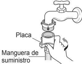
**Conexión de la manguera a presión con el grifo sin rosca**
