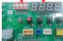
Плата наружного блока
