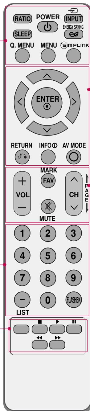
**THUMBSTICK** (Arriba/Abajo/Izquierda/Derecha/ENTER) Le permite navegar a través de los menús en la pantalla y ajustar el sistema de acuerdo a sus preferencias.
