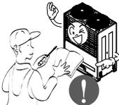
Instale siempre un circuito y un interruptor específico.
