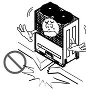
**Asegúrese de que el soporte de instalación no se deteriora con el tiempo.**
