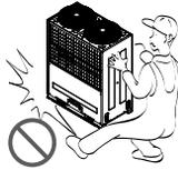
**No instale el aparato donde quede expuesto directamente al viento del mar (rocío salino).**
