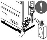
**Instale la manguera de drenaje para asegurarse de que el agua se drena correctamente.**
