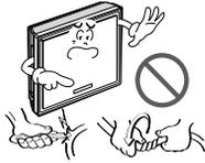
Das Klimagerät sollte bei extrem hoher Luftfeuchtigkeit oder bei geöffneten Türen/Fenstern nicht lange betrieben werden.
