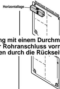
7. Bohrung mit einem Durchmesser von 50 mm für Rohranschluss vornehmen (Bei Verlegen durch die Rückseite)
