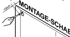
9. Öffnung des Gerätes mit den Dübeln ausrichten, die unteren und dann die oberen Schrauben festziehen.
